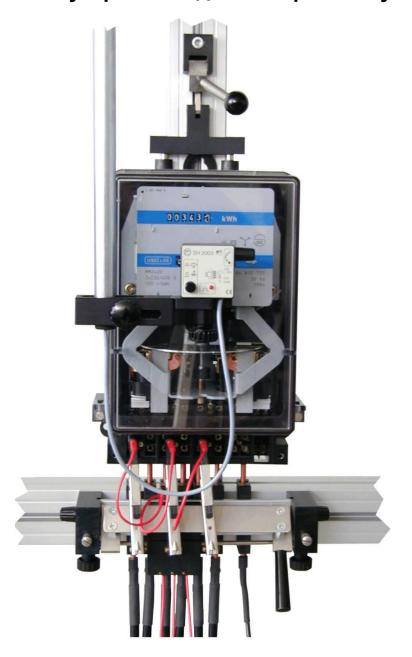
Быстрозажимные устройства QCD применяются в составе установок для поверки электросчетчиков. Они используются для того, чтобы ускорять подвеску и включение счетчиков с целью экономии времени в процессе их регулировки или поверки.
